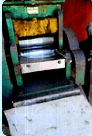
Hình 6.9. Bước cán bạc
